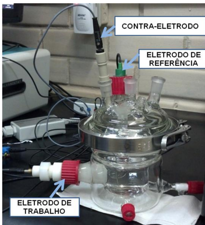
Figura 14 – Célula eletroquímica com os 3 eletrodos em destaque
