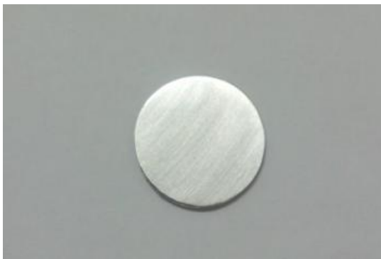
Figura 12 – Amostra cortada e lixada
