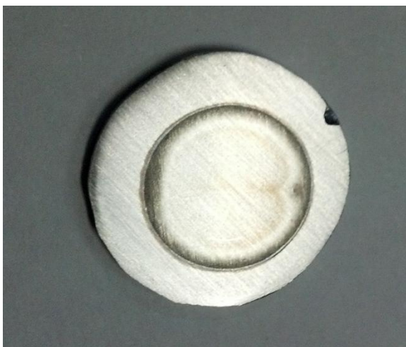
Figura 17 – Amostra após o ensaio de polarização potenciodinâmica cíclica
