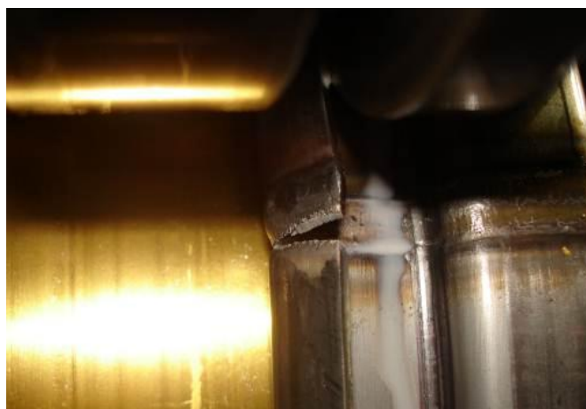
Figura 25 – Trinca na região da ZTA [2].
