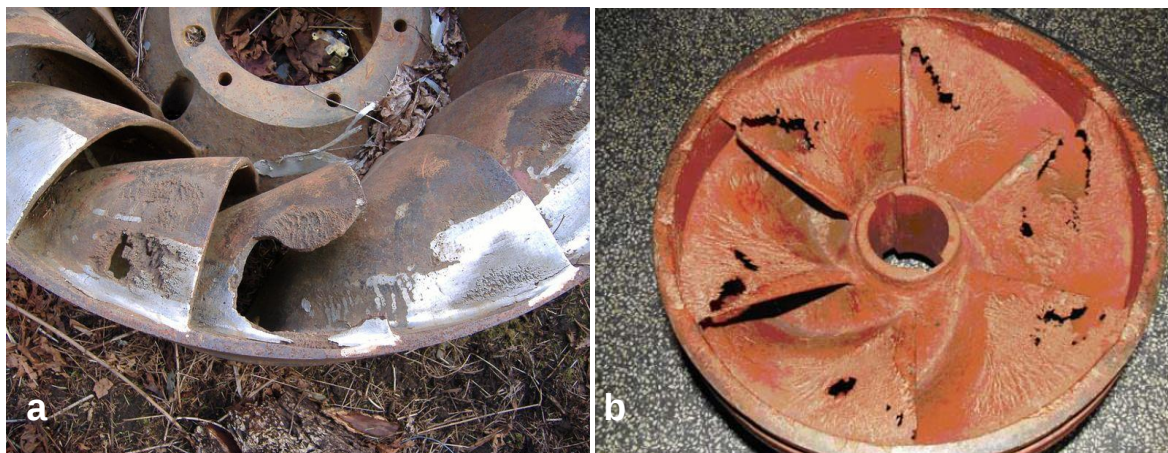
Figura 2.3 – a) Rotor de turbina Francis apresentando dano erosivo por cavitação. b) Rotor de bomba centrífuga danificado por cavitação.
