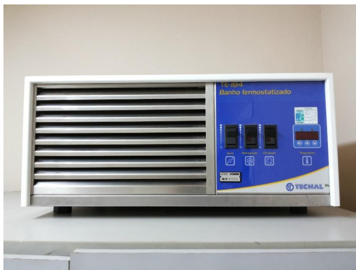
Figura 3.2 - Equipamento Banho Termostático, Tecnal, modelo TE-180
