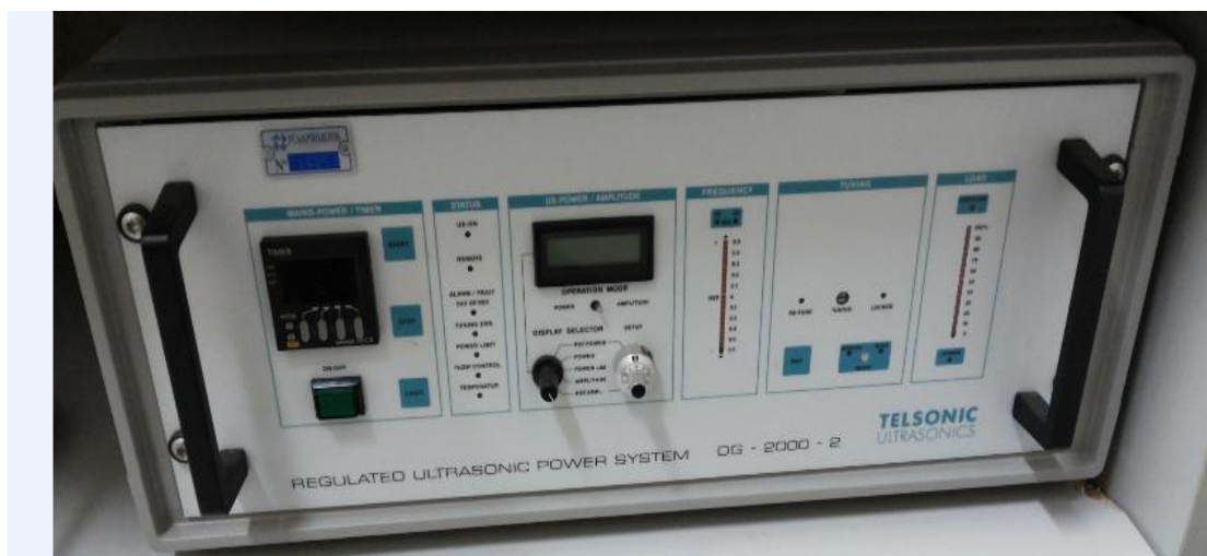
Figura 3.3 - Equipamento Gerador de ultrassom, Telsonic DG-2000
