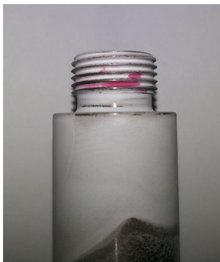
Figura 4.10 – Ensaio de líquido penetrante que comprovou a falha no sonotrodo.
