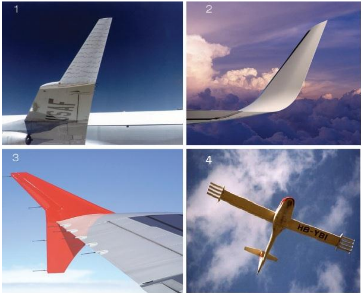
Figura 12 - Alguns dispositivos de ponta de asa. 1 – Winglets , 2 – Blended winglets , 3 – Wind fences e 4 – Wing grids .
