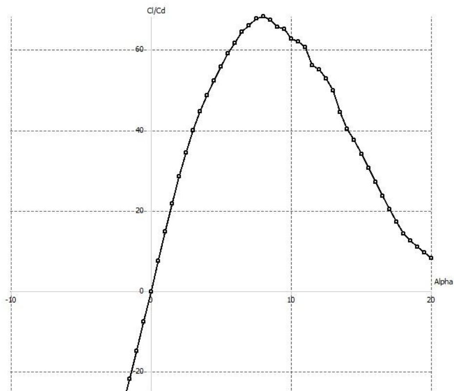
Figura 7 - Exemplo de polar da razão CL/CD para um perfil NACA 0010
