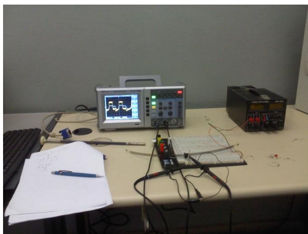
Figura 17: Experimento realizado para o levantamento do circuito do sensor de contagem para determinação da deformação das molas.
