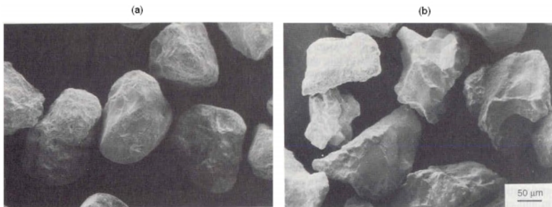
Figura 8: Partículas de sílica, visualizadas no Microscópio Eletrônico de Varredura, (a) partículas arredondadas e (b) partículas angulosas. Fonte: HUTCHINGS (1992).
