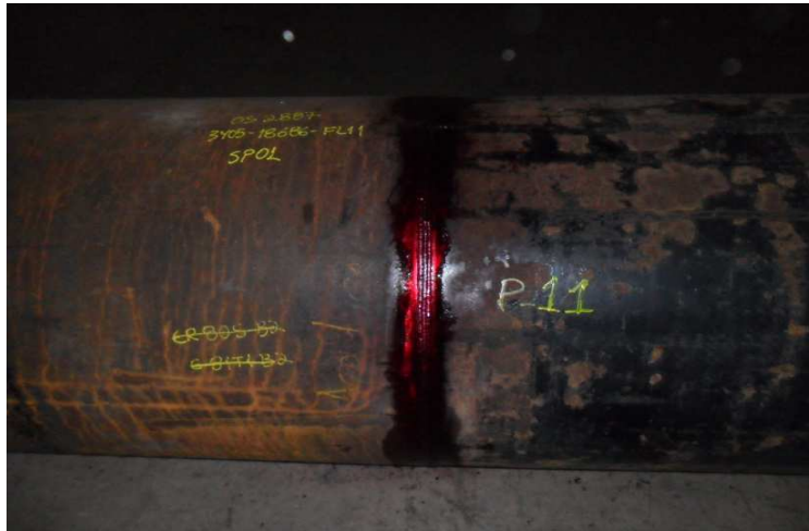
Figura 37: Foto de um ensaio por líquido penetrante em uma junta.
