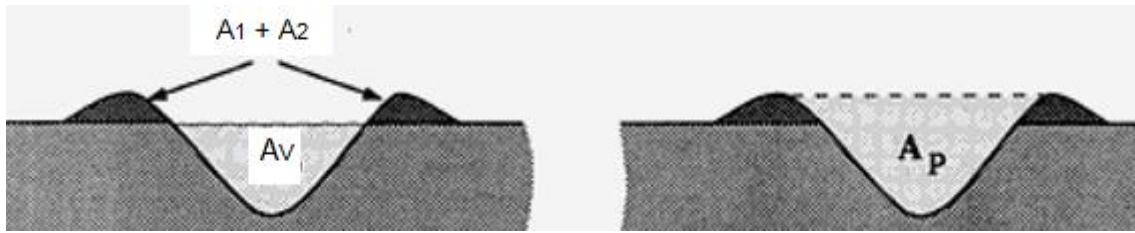
Figura 4 – Esquema da seção transversal do sulco formado. Fonte: (Adaptado de JACOBSSON et al, 1992)
