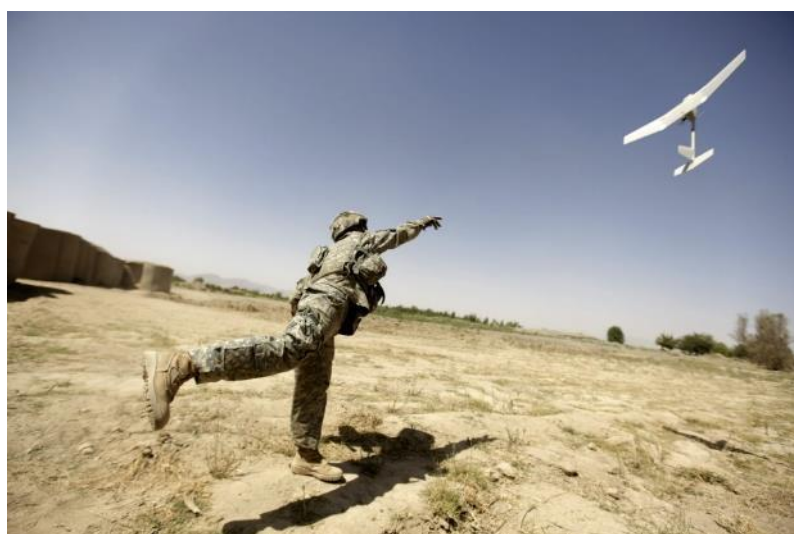
Figura 8 - Drone de asa fixa sendo lançado manualmente. Fonte: NBC News
