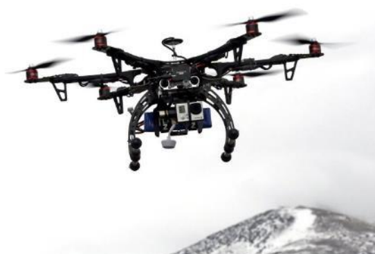
Figura 10 - Drone equipado com seis asas rotativas. Fonte: NBC News
