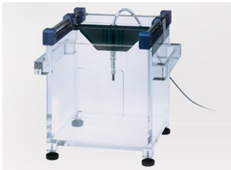
Figura 14 – Exemplo de ferramenta usada para calibrar a potência do feixe de acordo com o posicionamento do robô Fonte: http://www.iba-dosimetry.com/
