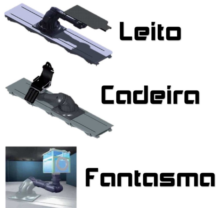
Figura 15 – Desenho esquemático das possíveis configurações robô/ferramenta
