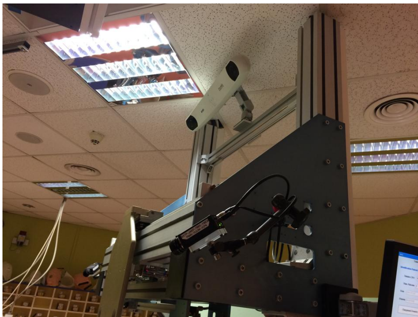
Figura 22 – Posicionamento da câmera infravermelho na sala de tratamento
