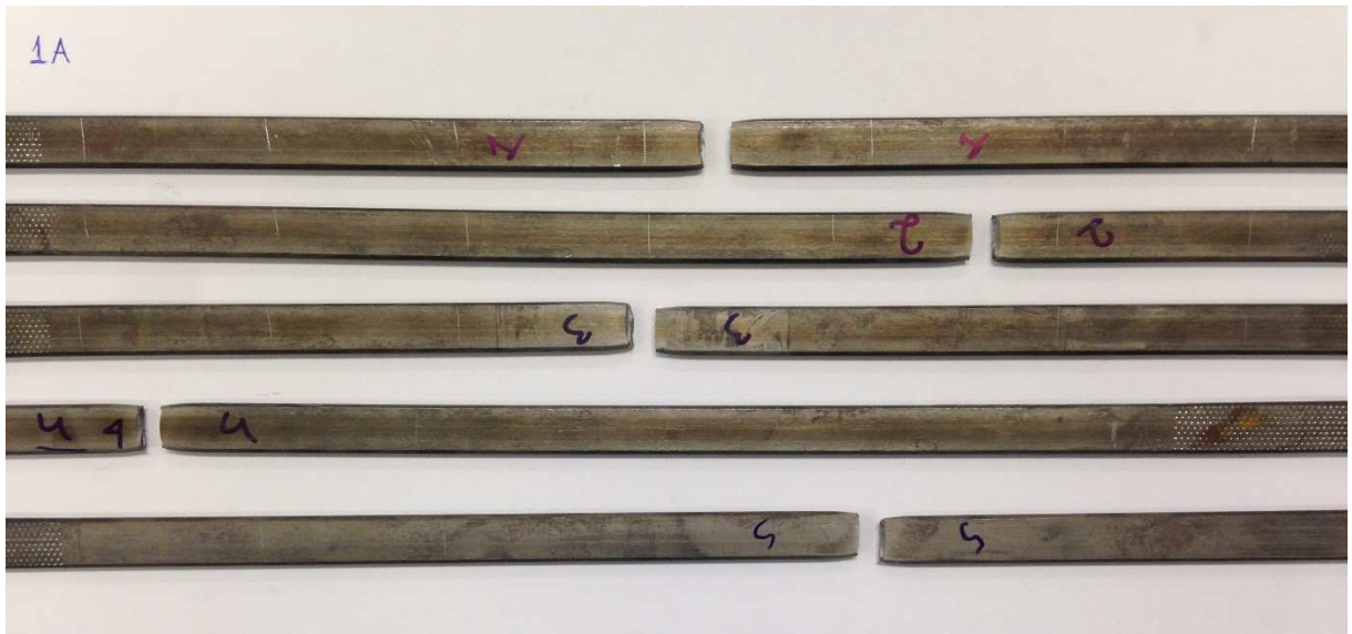
Figura 17: corpos de prova após ensaio de tração, referentes ao lote 1A
