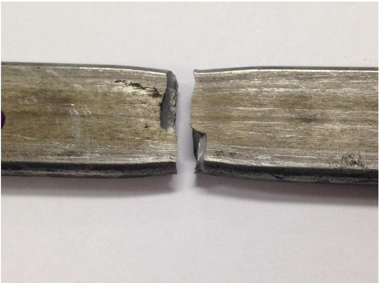
Figura 18: detalhe da fratura dúctil
