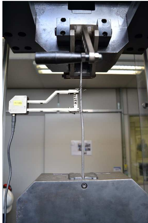
Figura 15: corpo de prova pronto para ser ensaiado na máquina de tração
