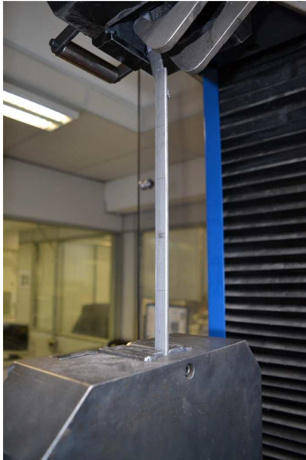
Figura 16: corpo de prova rompido após o ensaio de tração
