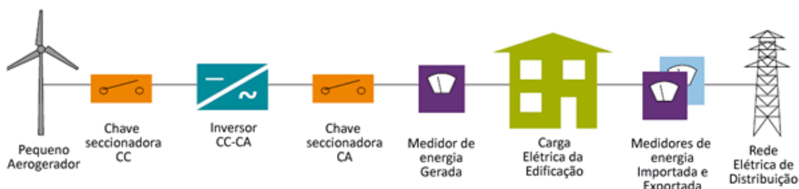
Figura 12 - Esquema simplificado de sistema eólico de pequeno porte conectado à rede. Fonte: CARBON TRUST, 2008.
