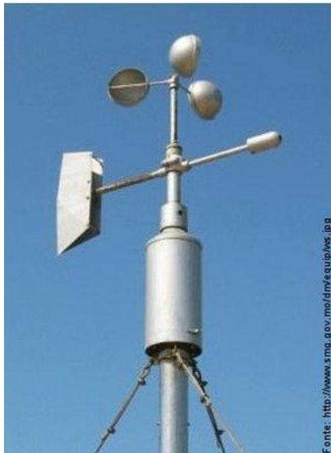
Figura 13 - Anemômetro de copos. Fonte: http://www.smg.gov.mo
