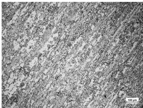
Figura 26 - Metalografia da amostra tratada termicamente a 475°C. (a) Durante 4 horas; (b) Durante 12 horas. Ataque: Behara.
