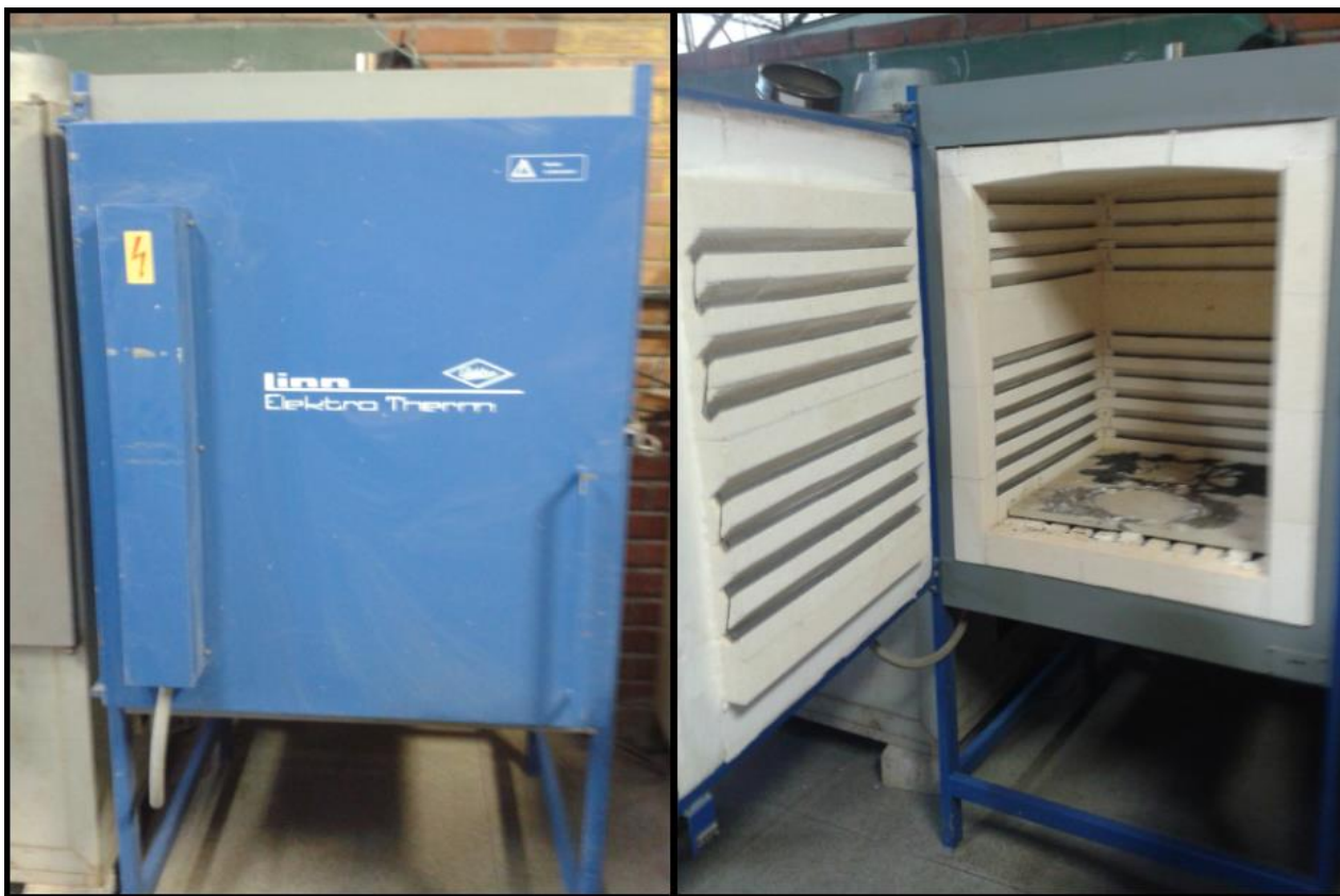
Figura 17 – Mufla com capacidade térmica de até 1400°C
