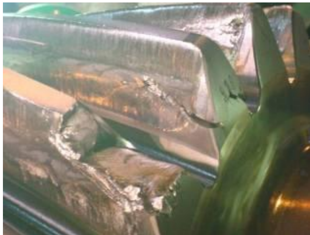
Figura 37 - Dente quebrado. Fonte: ArcelorMittal Tubarão
