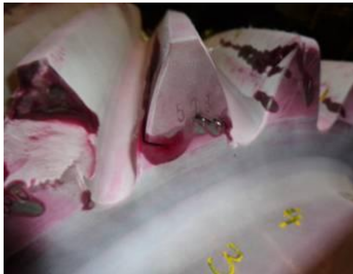
Figura 36 - Ensaio de líquido penetrante. Fonte: ArcelorMittal Tubarão
