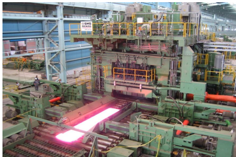
Figura 3 - Laminador de tiras a quente. Fonte: AZE Steel
