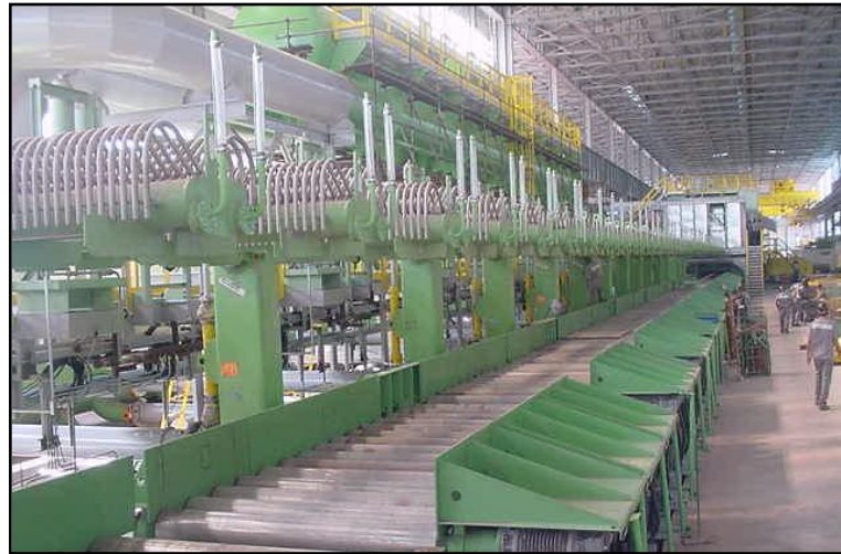
Figura 12 - Mesa de resfriamento. Fonte: ArcelorMittal Tubarão
