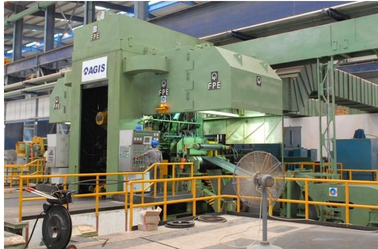
Figura 2 - Laminador de tiras a frio. Fonte: CMI Rolling Mills
