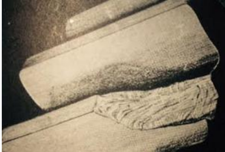
Figura 27 - Dente de engrenagem que falhou por sobrecarga. Fonte: LYNWANDER (1984).
