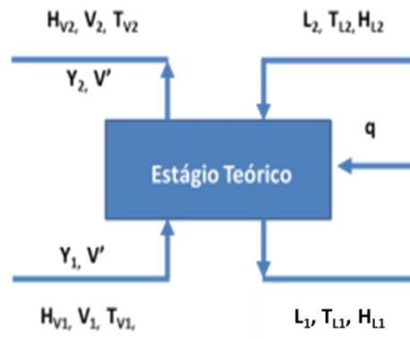
FIGURA 4: Estágio teórico típico do processo de umidificação
