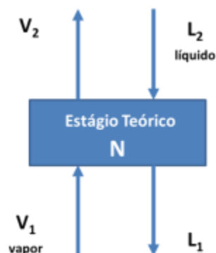
FIGURA 3: Andar ou Estágio teórico (adaptado de The ChemSep Book, 2006, p.191)
