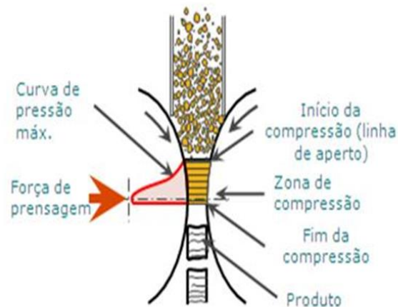
Figura 32 - Princípio da cominuição na prensa de rolos Fonte: VALE, 2014.
