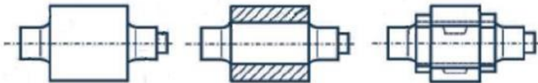
Figura 7 - Tipos de rolos: inteiriços (esq.), anel (centro), segmentados (dir.) Fonte: Broeckmann e Gardula, 2005.
