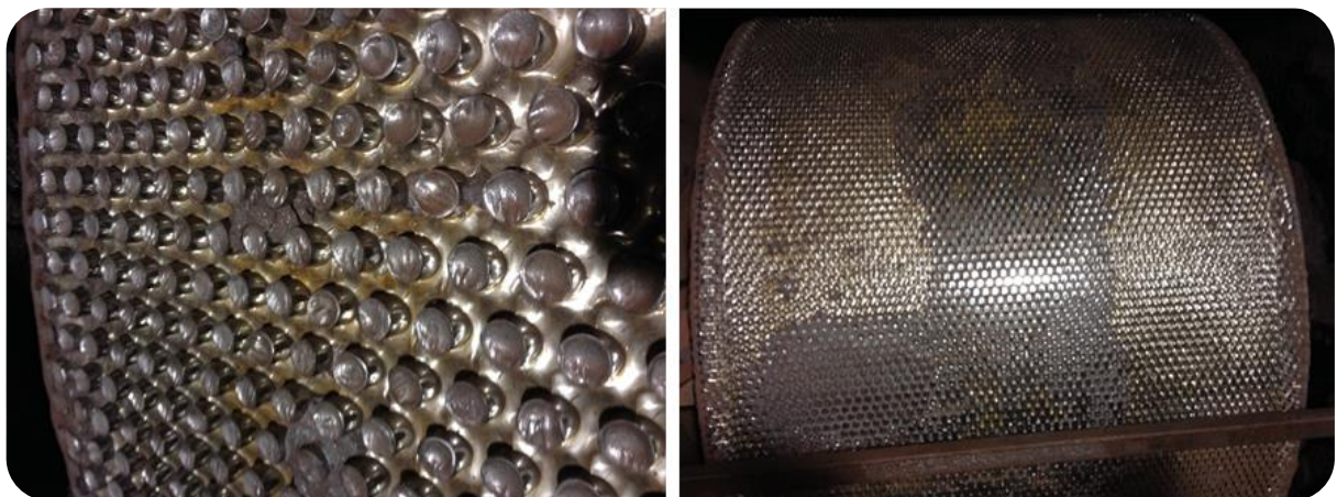
Figura 29 - Desgaste na capa superior ao esperado (região clara) Fonte: VALE, 2014.
