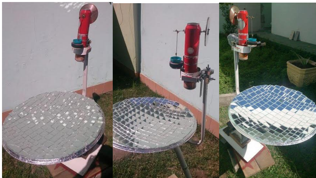
Figura 32 - Motor Stirling tipo Gama com coletor solar parabólico – Modelo didático. Fonte: Autor (2015)
