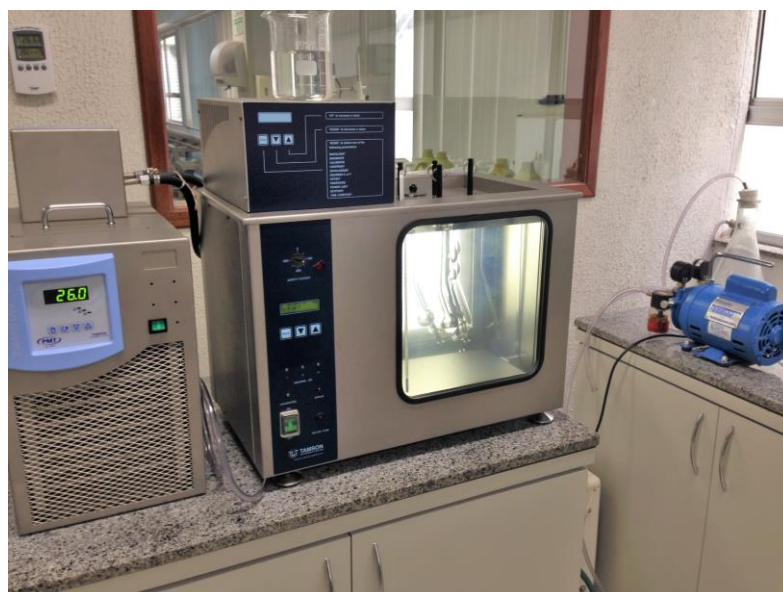
Figura 9. Validação dos teste, verificação da viscosidade
