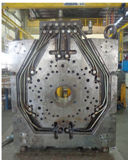
Figura 3 – Molde (Lado Fixo – Câmara fria)
