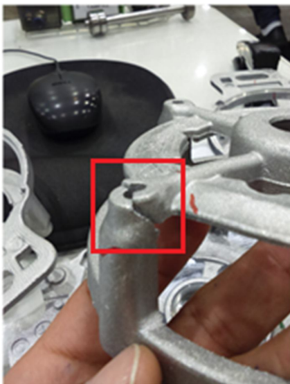
Figura 14 – Peça com presença de rachadura (provocada no momento de extração do molde)
