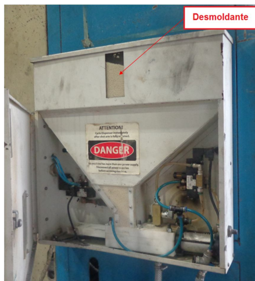
Figura 34 – Aplicação do desmoldante
