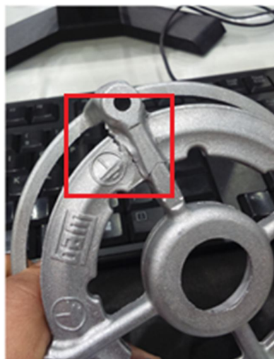
Figura 15 – Peça com presença de rachadura (provocada no momento de extração do molde)
