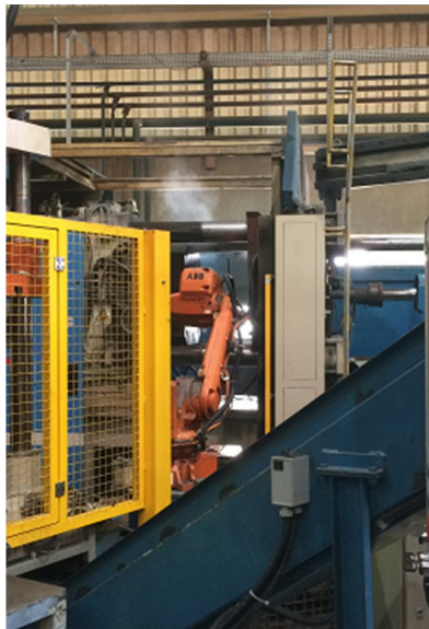
Figura 35 – Abertura dos moldes para futura retirada das galhas
