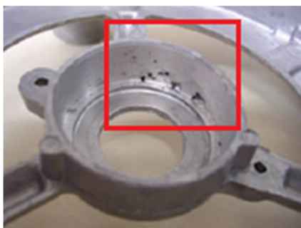
Figura 18 – Peça com falha de injeção (provocada por porosidade)
