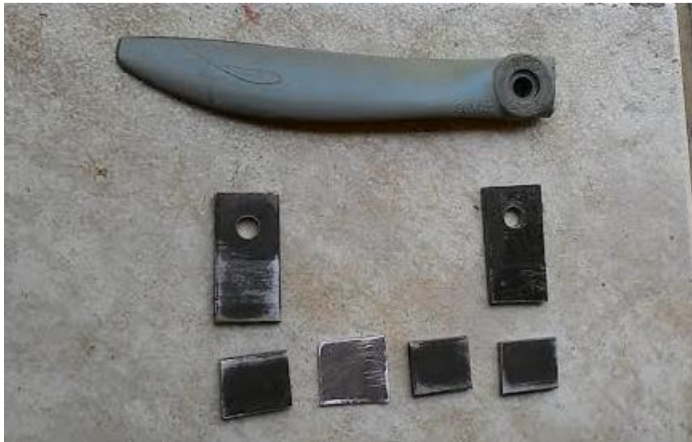
Figura 14 – Confeção da hélice mono-pá 12,25x3,75.
