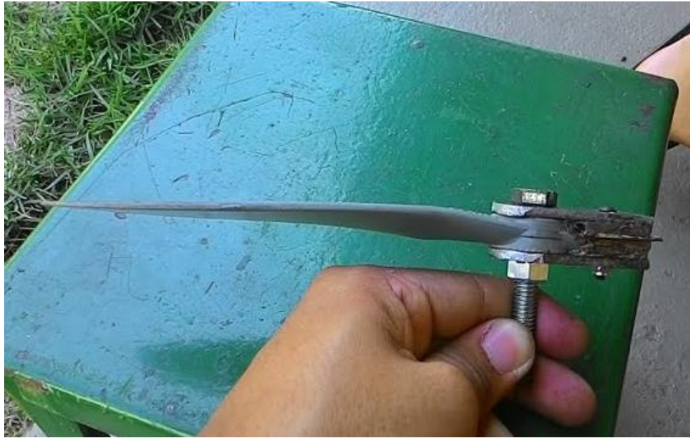
Figura 15 – hélice mono-pá 12,25x3,75 antes do balanceamento.
