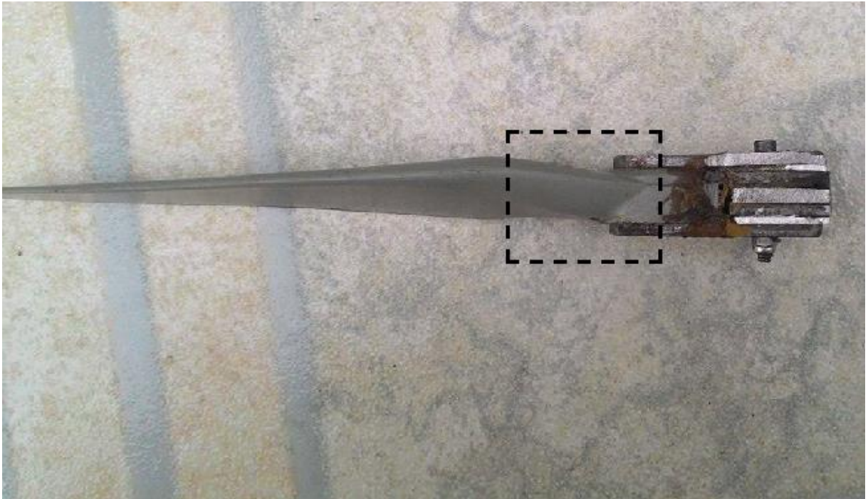
Figura 12 – Transição entre a pá e o cubo.
