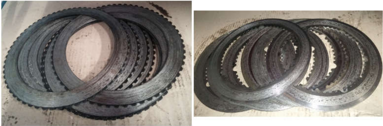
Figura 17: Discos de freio internos e externos avariados
