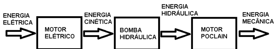
Figura 10: Esquema simplificado da transformação da energia ao longo da máquina Hot Car
