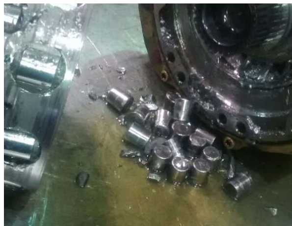
Figura 14: Roletes e pequenas partes do rolamento quebrado
