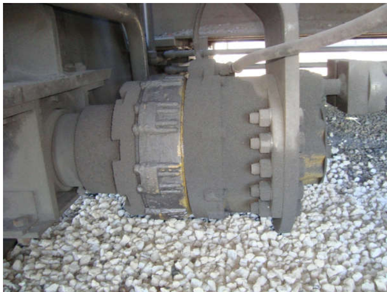
Figura 9: Poclain MS35 instalado na máquina Hot Car
