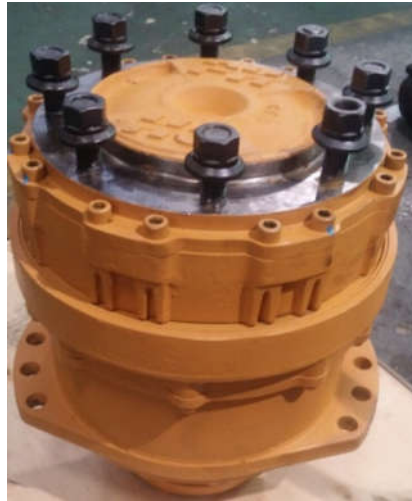
Figura 12: Poclain após montagem, teste e pintura nas instalações da Hesidral, pronto para retornar à área da ArcelorMittal
