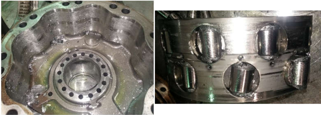
Figura 15: Anel elíptico, bloco e pistões avariados
