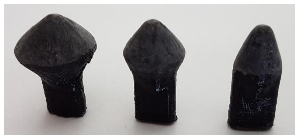
Figura 41 - Pontas cônicas obtidas por impressão 3D.
