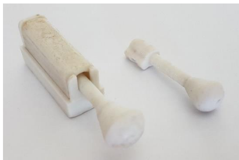
Figura 42 - Pontas esféricas obtidas por impressão 3D e apalpador montado.
