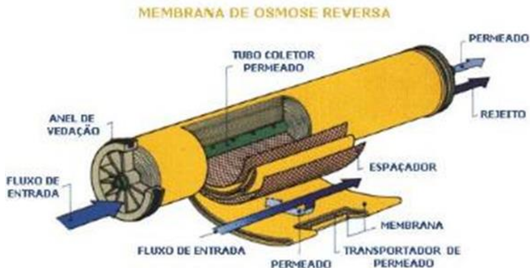
Figura 2.5 Modelo da membrana de sistema de osmose reversa
