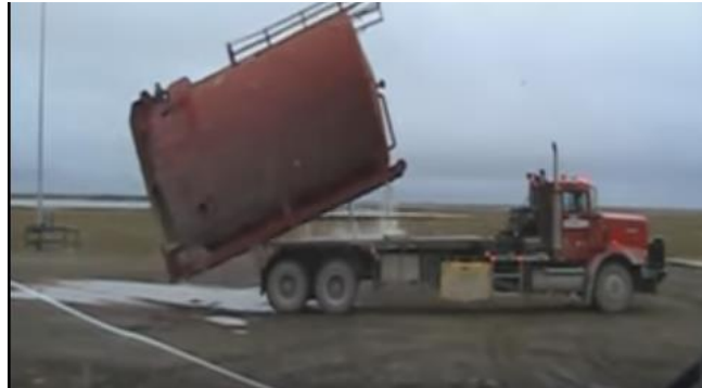
Figura 14 - Oilfield Bed Truck em operação - Carga passando sob o Rolete
