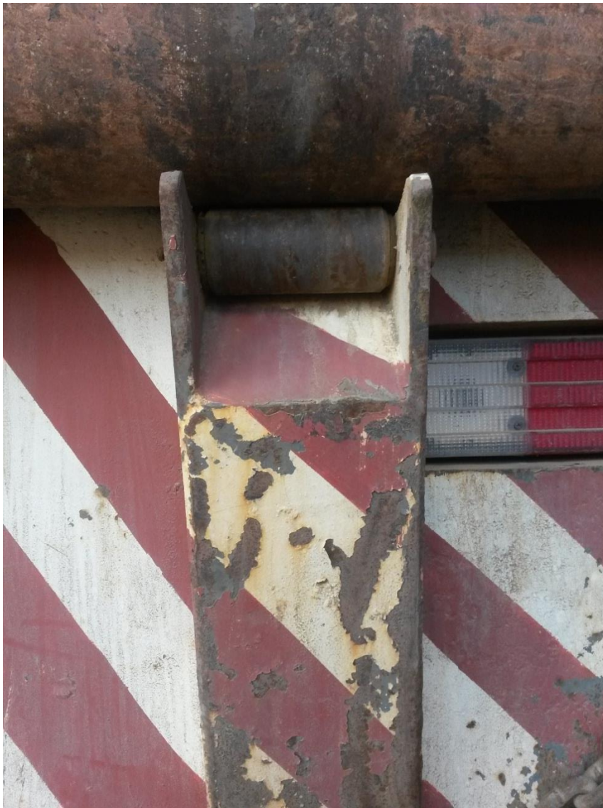
Figura 24 - Detalhe Rolete Auxiliar
