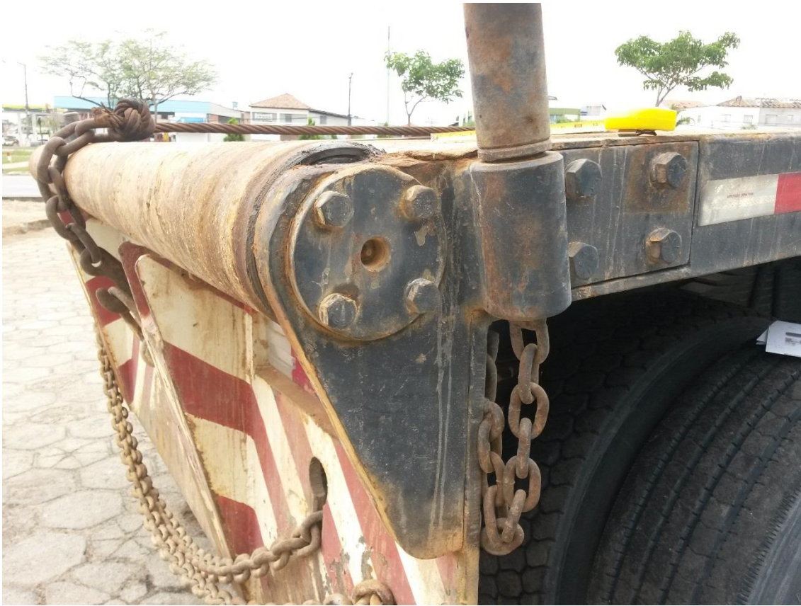
Figura 23 - Detalhe do fundo do equipamento - Rolete e parachoq ue
