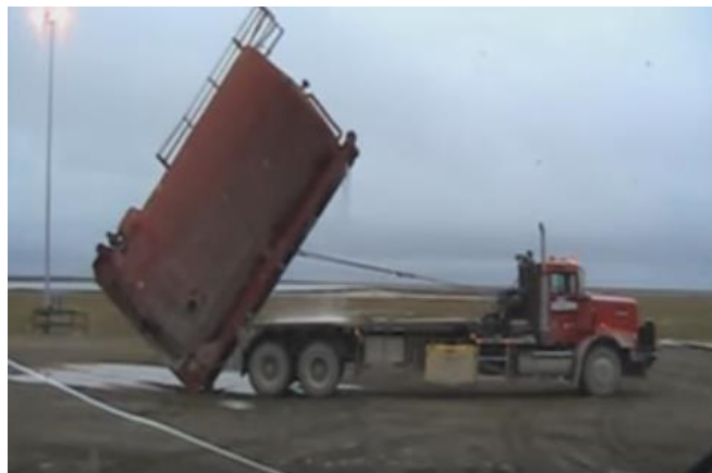
Figura 13 - Oilfield Bed Truck em operação - Deslizamento da carga
