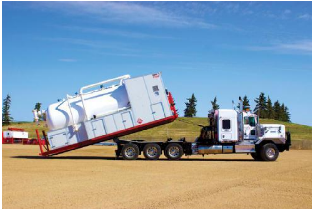
Figura 27 - OilField BedTruck movimentando um SKID com equipamentos diversos
