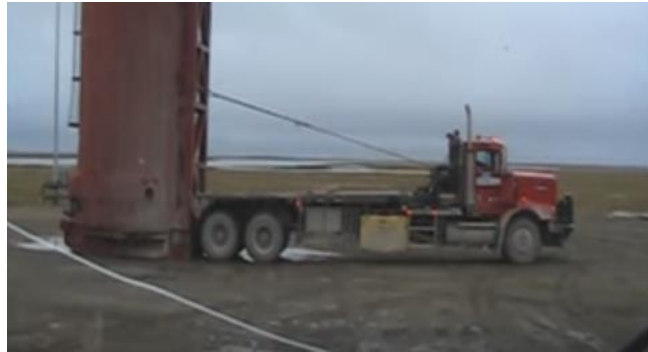
Figura 12 – Oilfield Bed Truck em operação - Afixação do gancho na carga
