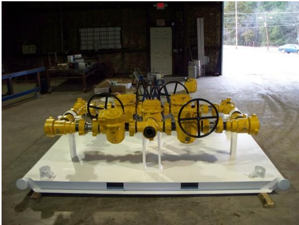
Figura 26 - SKID utilizado para acomodar um Manifold
