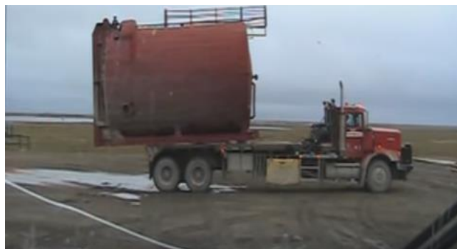
Figura 15 - Oilfield Bed Truck em operação - Carga acomodada sob a Plataforma
