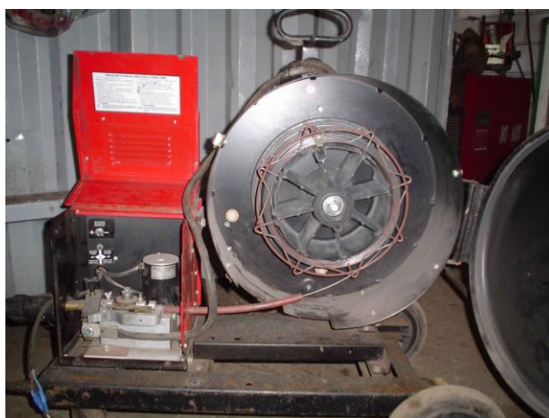
Figura 6 – Apresenta o cabeçote utilizado para alimentação do arame
