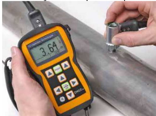
Figura 4 - Medição de Espessura por Ultrassom
