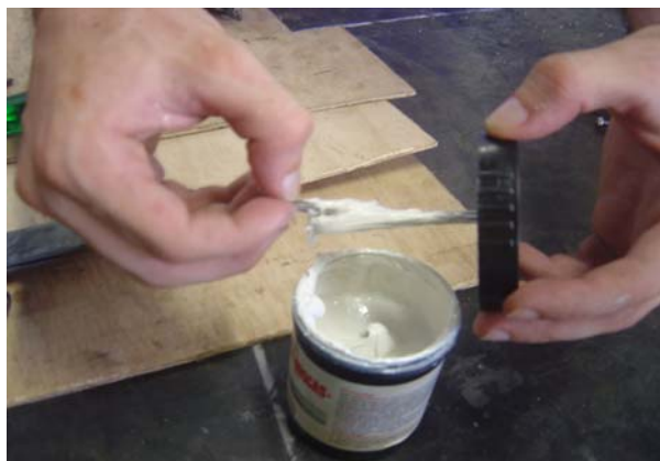
FIGURA 25 : Aplicação de veda rosca industrial para vedação.
