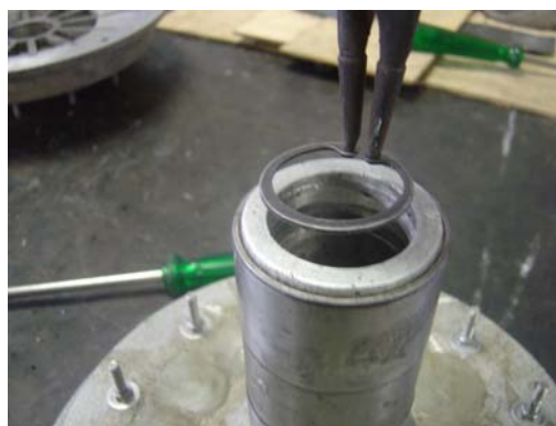
FIGURA 18 : Montagem do anel interno no estator.
