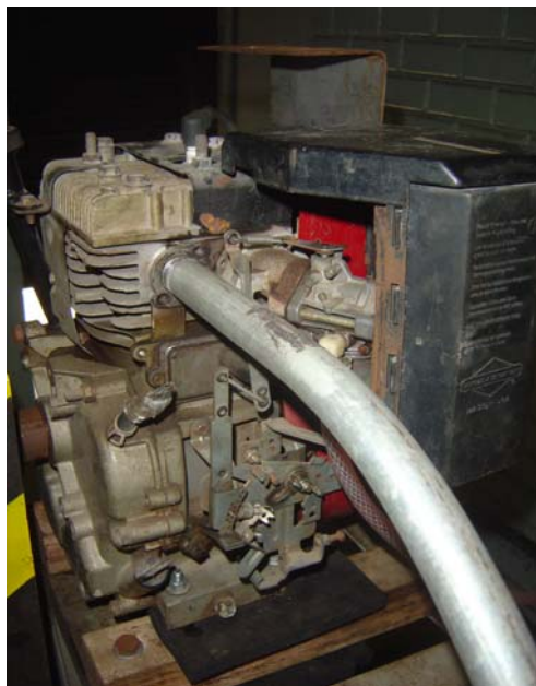
FIGURA 39 : Tubo com rosca para saída.
