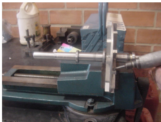
FIGURA 22 : Removendo material do rotor.
