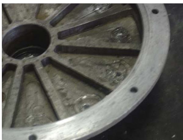
FIGURA 26 : Aplicação de silicone para vedação.
