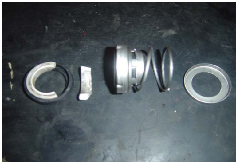
FIGURA 43 : Selo mecânico danificado.
