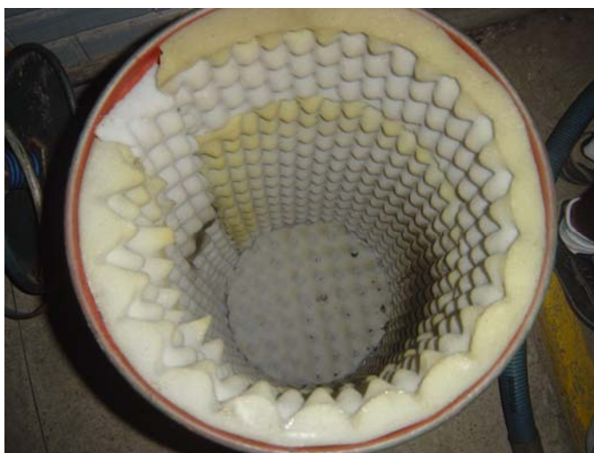
FIGURA 41 : Montagem da espuma em todo interior do latão.
