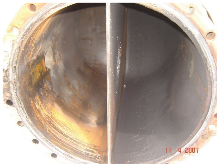
Figura 9 – Detalhe interno do cabeçote ilustrando a divisão das câmaras de distribuição do fluido primário.
