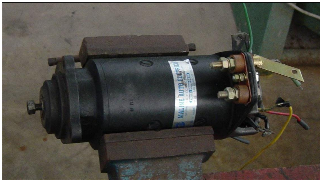
Figura 35: Motor de arranque passando por adaptações
