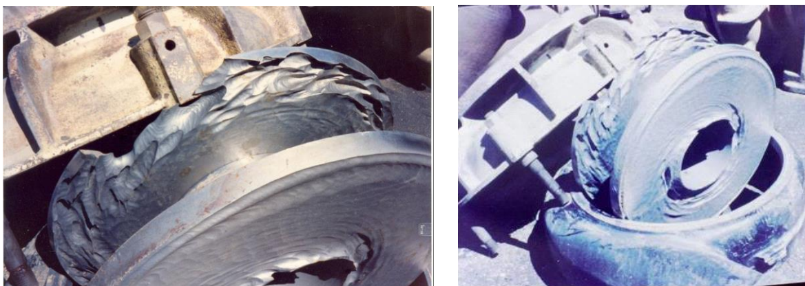
Figura 20 – Rotor de bomba centrífuga com desgaste provocado por cavitação.
