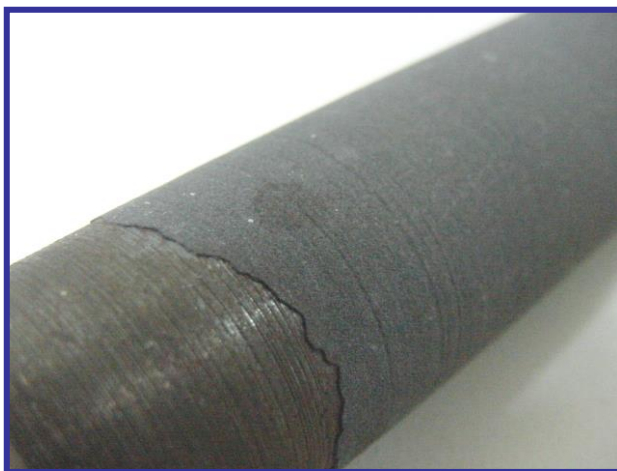
Figura 8 – Diferença entre a parte revestida com cerâmica e a não revestida.
