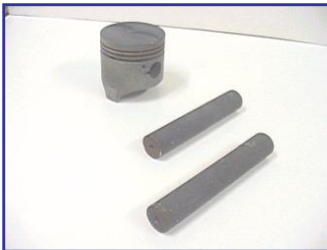
Figura 7 – Peças Revestidas com cerâmica, Através da técnica de plasma spray.
