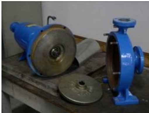
Figura 32 e 33. Desmontagem para vedação da carcaça com Sikaflex.
