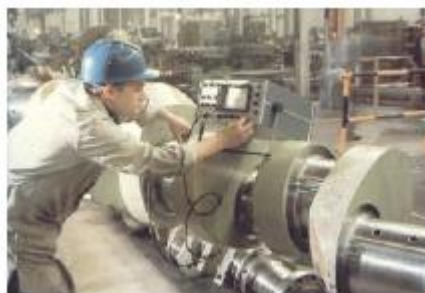
Figura 3-3 Realização do teste de ultra-som
