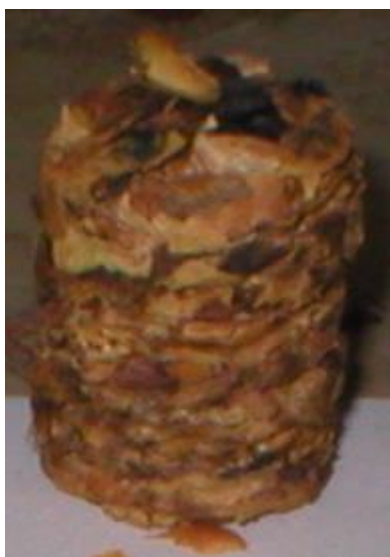
Figura 14 - Palha compactada a frio
