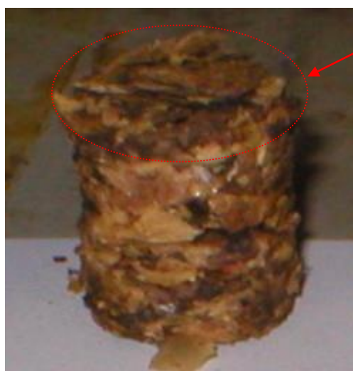
Figura 16 - Detalhe da palha em contato com a umidade
