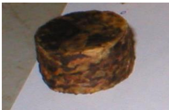
Figura 15 – Palha compactada com aquecimento
