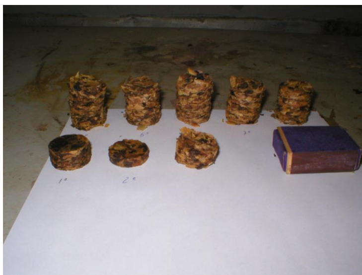
Figura 20 – Amostras compactadas na prensa metalográfica
