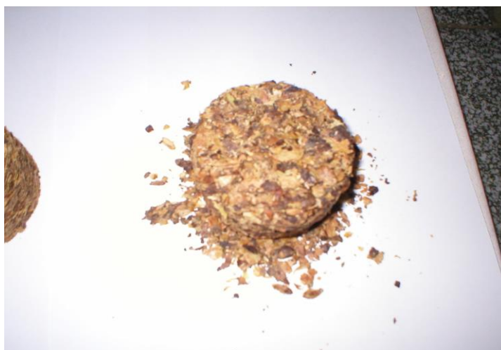
Figura 33 – Compactação com carga de 20 ton.
