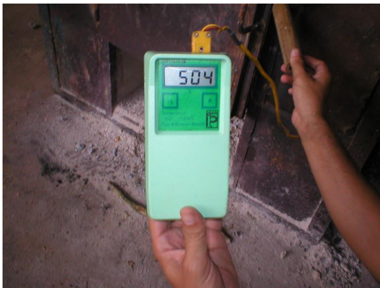
Figura 7.07 – Utilização do Termopar para determinar temperatura
