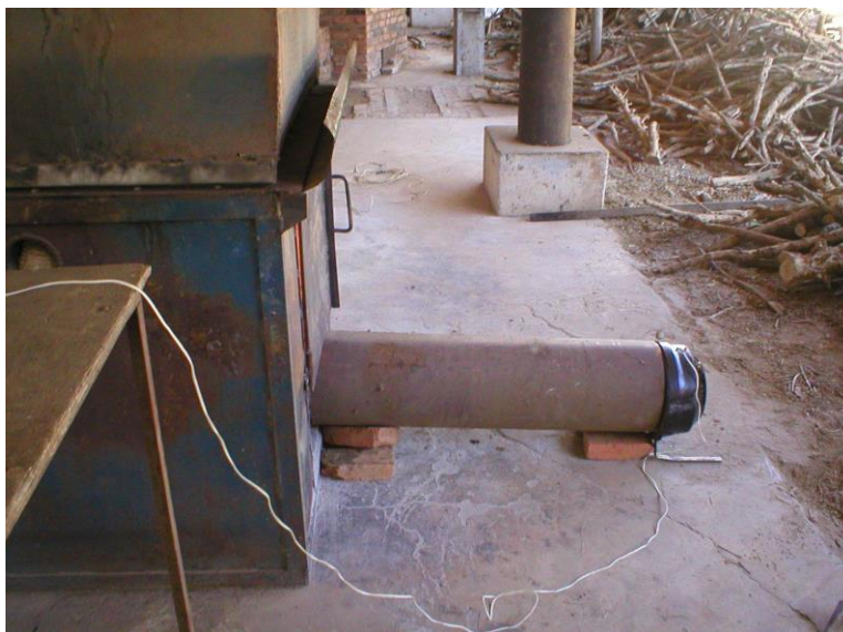
Figura 7.01 – Tubo metálico com alto – falante
