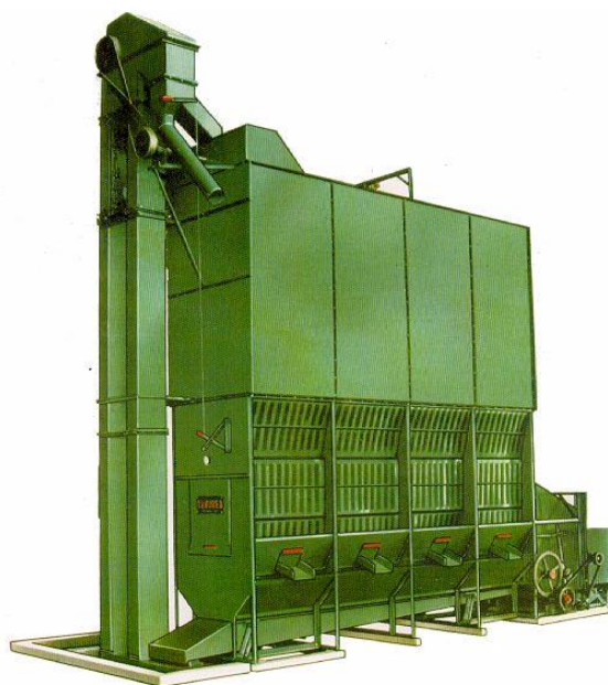
Figura 4.03 – secador vertical com câmara de repouso ou tipo baú
