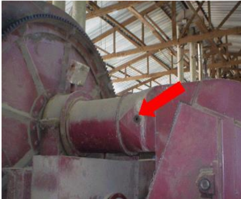
Figura 7.09 – Local de medida da temperatura e vazão do ar de secagem
