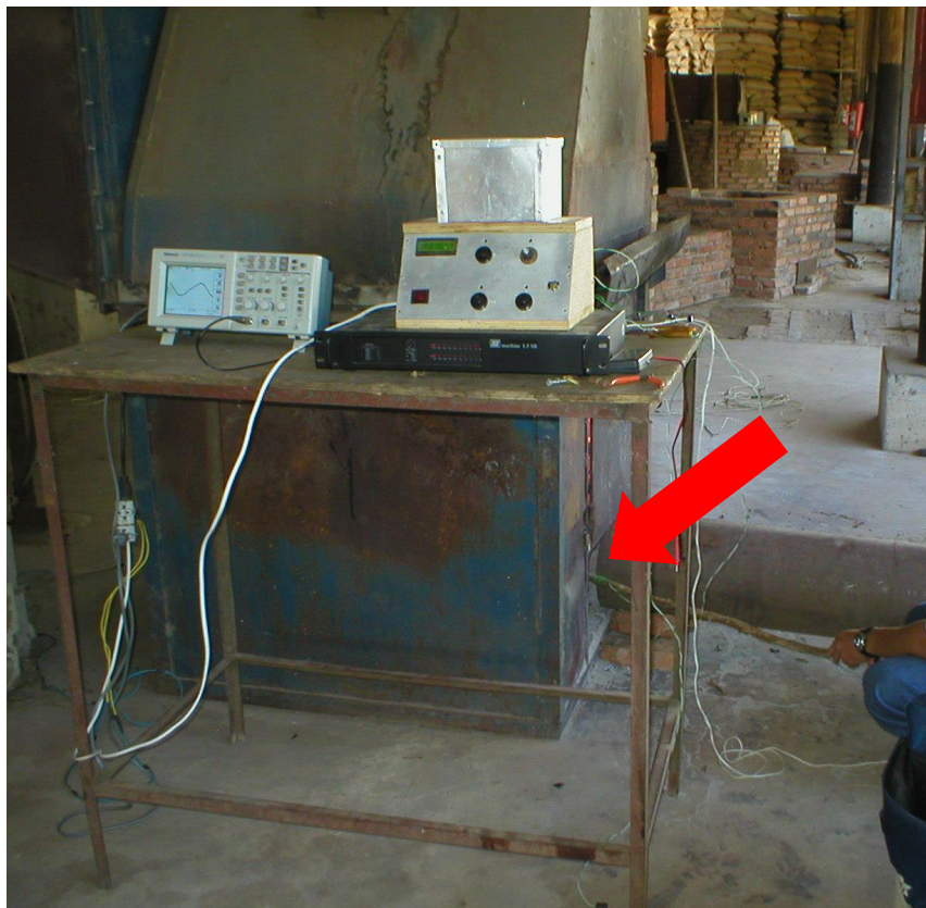
Figura 7.02 – Posicionamento do sensor (microfone)
