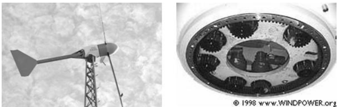
Figura 17 - Mecanismos Yaw utilizadas nas turbinas eólicas horizontais upwind [1].
