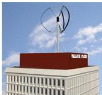
Figura 23 - Turbinas eólicas verticais acionadas pelas forças de sustentação (Dermont, Neoga e Turby) [22].
