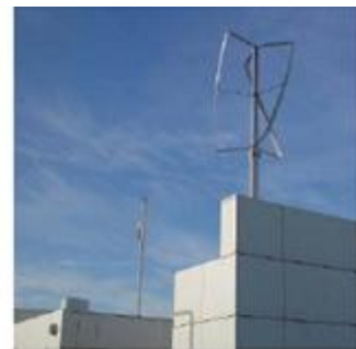
Figura 23 - Turbinas eólicas verticais acionadas pelas forças de sustentação (Dermont, Neoga e Turby) [22].
