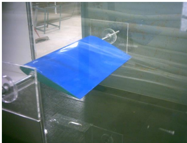
Figura 21 Aerofólio em madeira e revestido com plástico térmico
