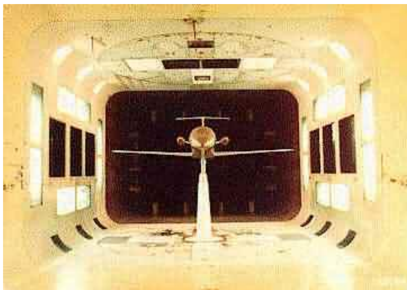
Figura 2 Seção de teste do túnel de vento do ITA
