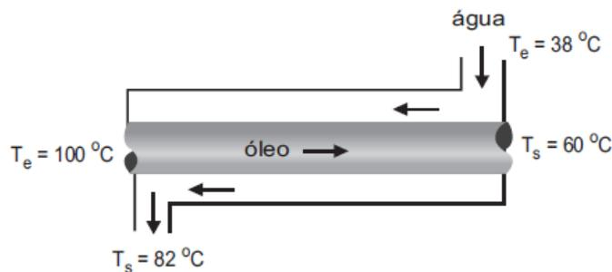
Um trocador de calor bitubular é utilizado para resfriar o óleo lubrificante de um motor, conforme ilustra a figura acima. A vazão mássica da água de resfriamento é de 0,2 kg/s. O coeficiente global de transferência de calor é 300 W/m<sup>2</sup>.K. Considerando-se que a média logarítmica das diferenças de temperaturas  $\Delta T_{ml}$  corresponde a, aproximadamente, 20 K e que o calor específico da água é 4,2 kJ/kg.K, a área de troca de calor, em m<sup>2</sup>, seria:
