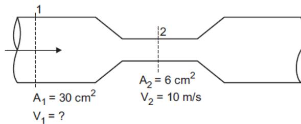
O tubo de Venturi é um tubo convergente-divergente, tal como o da figura acima, utilizado para medir a velocidade do escoamento e a vazão de um líquido incompressível. Considerando-se o escoamento do fluido em regime permanente através do tubo de Venturi apresentado e que o índice 1 se refere à seção de entrada do tubo e o 2, à seção da garganta, têm-se para a velocidade na seção de entrada, em m/s,
