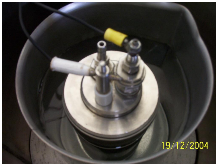
Figura 32 - Bomba no interior do banho calorimétrico.
