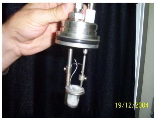
Figura 27 - Estrutura interna da bomba calorimétrica.
