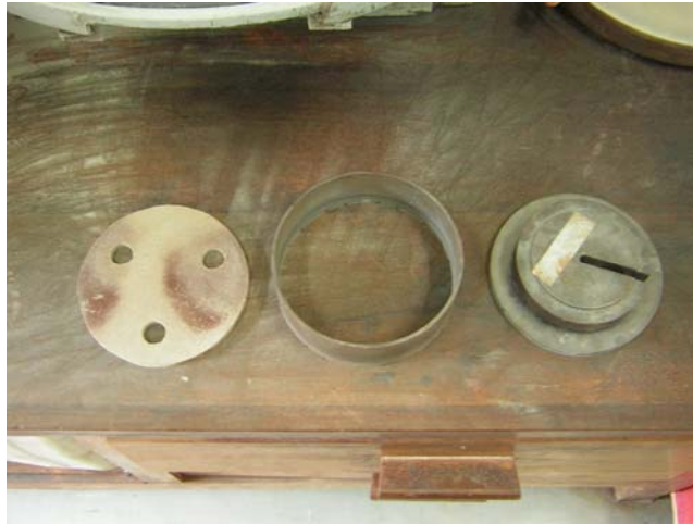
Figura 3.5 - Disco de Madeira, Casca Cilíndrica e Carga normal aplicada no ensaio (esquerda para direita).
