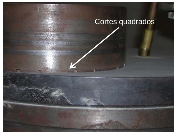
Figura 3.7 - Meio de entrada do abrasivo na interface amostra-disco.
