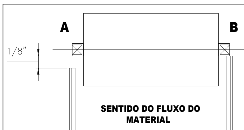
Figura 33- Tolerância de Nivelamento e Alinhamento de Tambores
