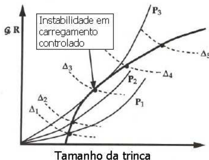
Figura 21 – Diagrama esquemático de Força de extensão da trinca G /Curva R que compara controle por carregamento e controle por carga (ANDERSON, 1995).
