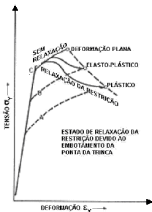
Figura 10 – Relaxação da restrição devido ao embotamento na ponta da trinca (FORTES, 2003).
