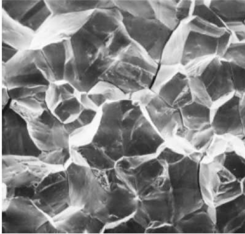
Figura 4 – Fractografia eletrônica de varredura mostrando uma superfície de fratura intergranular. 50X (CALLISTER, 2000).
