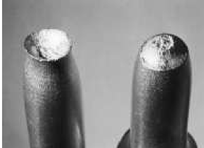
Figura 1 - Fratura dúctil do tipo taça e cone em alumínio (CALLISTER, 2000).
