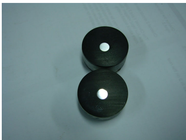
Figura 4-2 – Amostras utilizadas para metalografia
