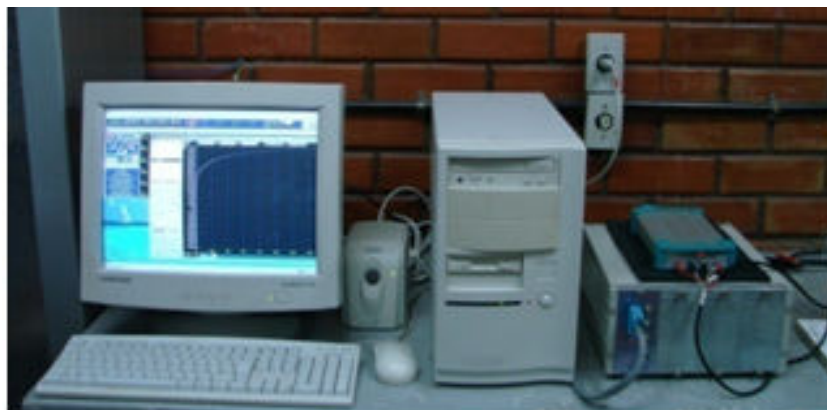
Figura 4-4 – Potenciostato utilizado nos ensaios de polarização
