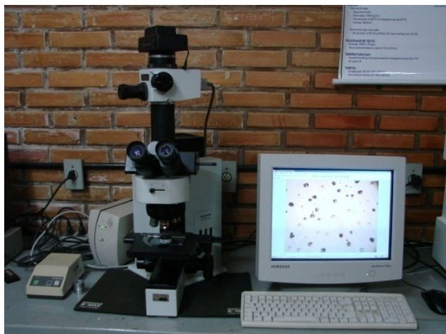
Figura 4-3 – Microscópio óptico utilizado na metalografia
