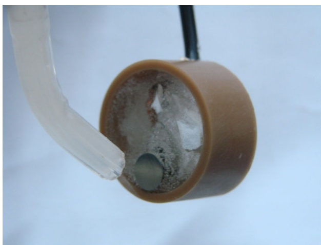
Figura 4-1 – Amostra utilizada no ensaio de polarização
