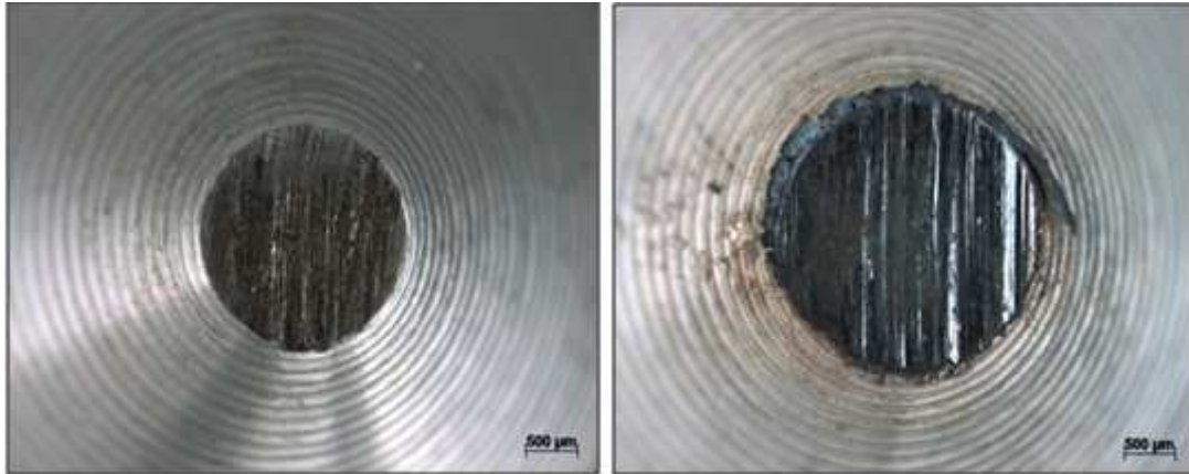
Figura 18: Pino após ensaio a frio, a esquerda, e pino após ensaio a quente, a direita. A carga utilizada em ambos os ensaios foi de 15,2 N. Podemos observar a diferença visual no diâmetro final para o ensaio a frio e a quente. (Fonte: Autor.)
