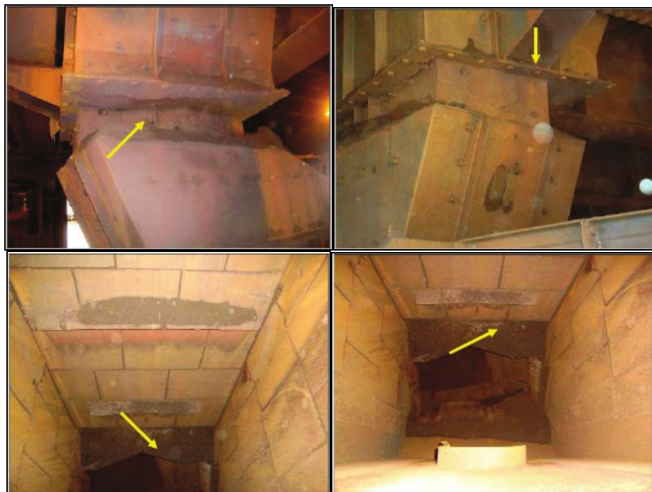
Figura 19 - Estreitamento da região intermediária do chute da TR-A3F para TR-A04A
