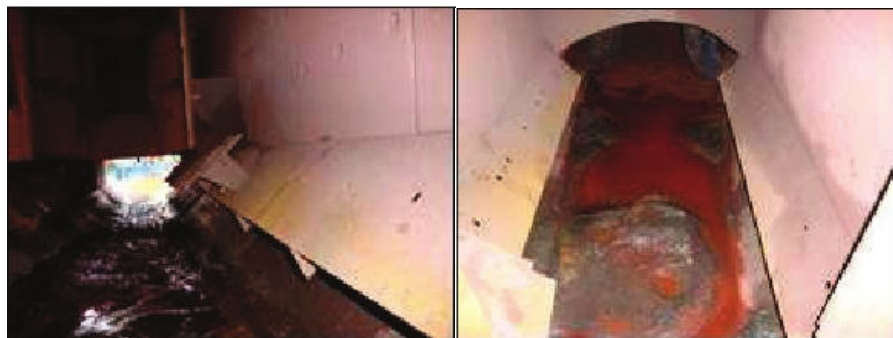
Figura 21 - Falta de rampa traseira do chute de transferência TR-A3F a TR-A04A
