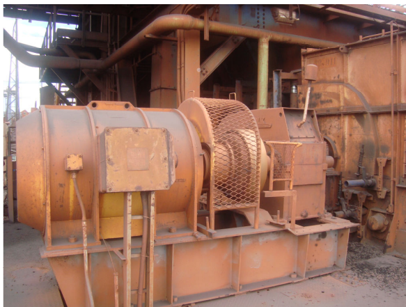
Figura 12 - Concepção de acionamento comumente utilizada para transportadores da VALE
