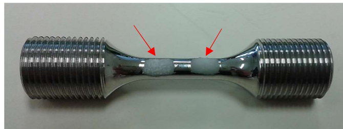
Figura 17: Corpo de prova polido até 1\mu\text{m} com pó de diamante e finalizado com os pontos de cerâmica
