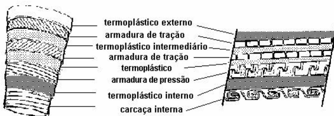
Figura 1 - Estrutura típica de duto flexível Fonte: (Souza, et al., 2000).
