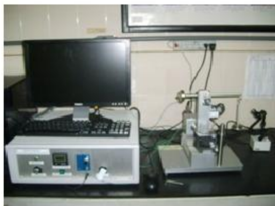
Figura 20 - Ilustração do equipamento de micro abrasão, ao lado uma fotografia do aparelho. Fonte: TE66 COMPEND 2000, (TRICORRMAT/UFES).
