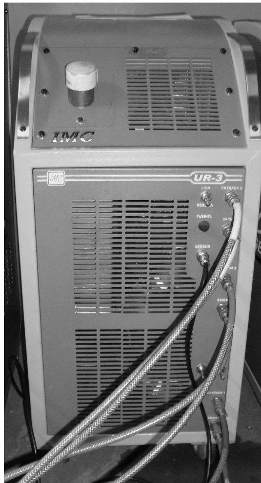
Figura 59 - Unidade de refrigeração
