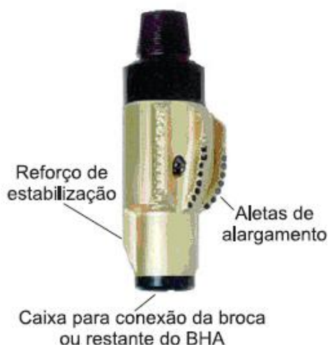
Figura 82– Alargador tipo DORWD, com tecnologia excêntrica Fonte: Rocha et al (2007).
