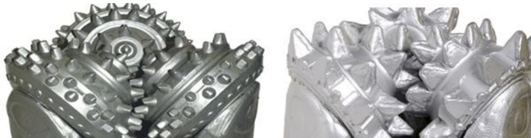
Figura 50– Broca tricônica com dentes de inserto de carbeto de tungstênio (á direita) e com dentes de aço (á esquerda). Fonte: Baker Hughes
