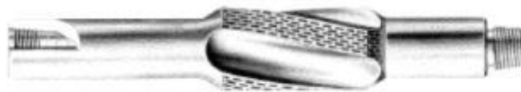
Figura 42– Estabilizador com lâminas integral ( Integral – blade stabilizer ) Fonte: Anadrill/Schlumberger (1996), modificado.
