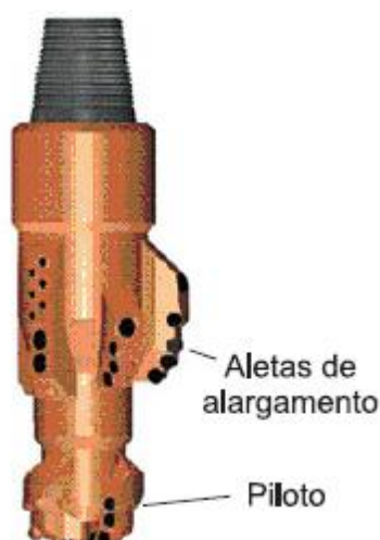
Figura 81- Alargador tipo broca bicêntrica, com tecnologia excêntrica Fonte: Rocha et al (2007).
