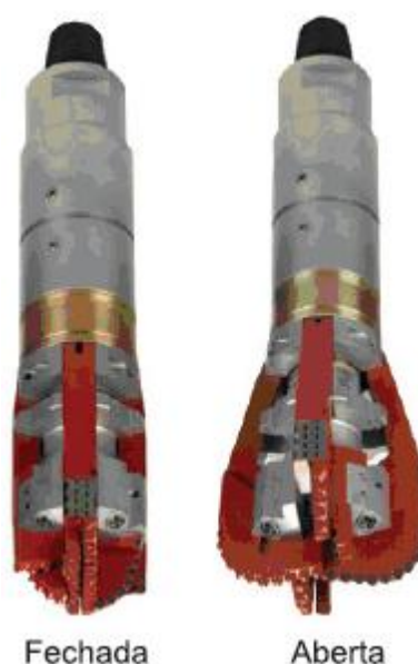
Figura 85– Alargador tipo broca expansível, com tecnologia concêntrica Fonte: Rocha et al (2007).
