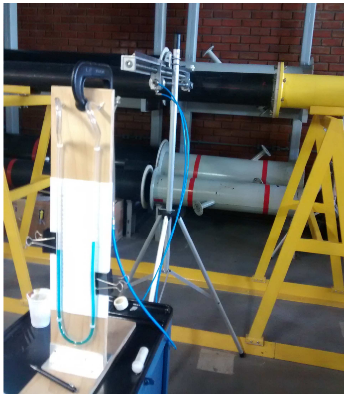
Figura 22. Instalação do medidor de pressão utilizado, manômetro em U.
