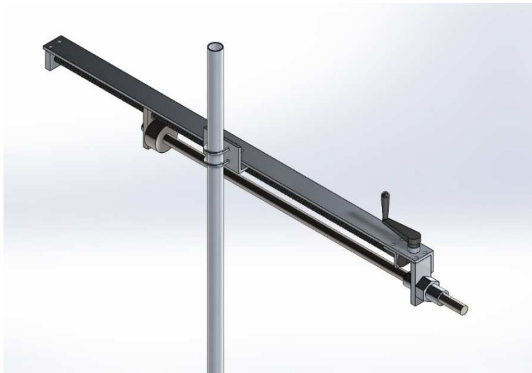
Figura 7. Desenho tubo de Pitot industrial
